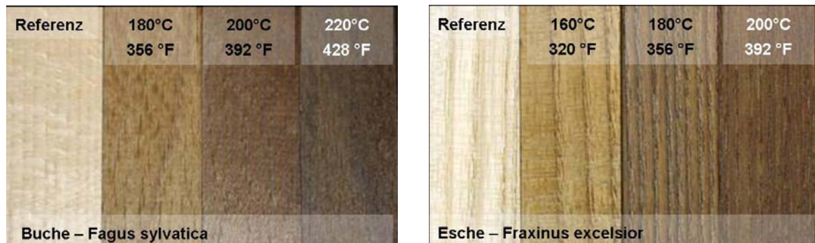
Abb. 6: Farbveränderung an Buchen- und Eschenholz mit steigender Behandlungsintensität
